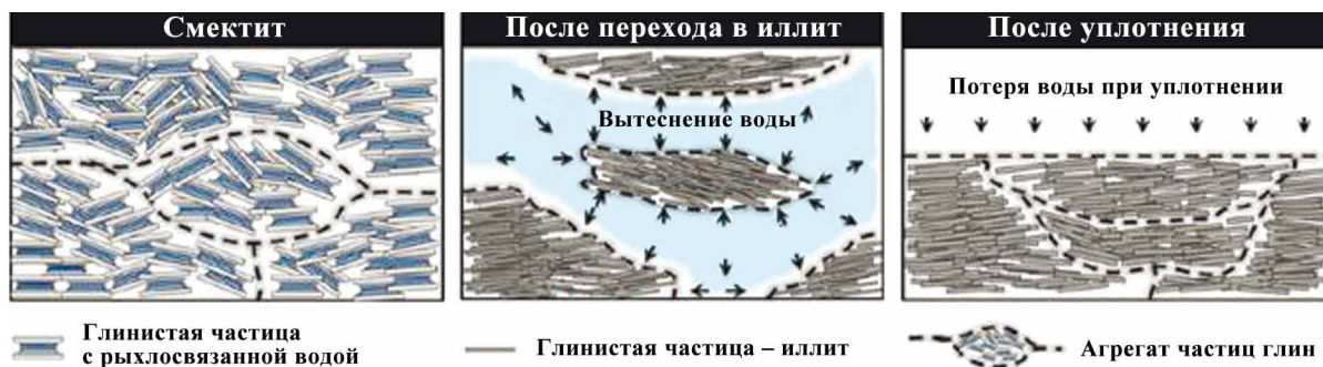
Рис. 6. Схема выделения межслоевой воды при преобразовании смектита в иллит и последующего уплотнения глинистой толщи (Al Duhailan, 2014).
