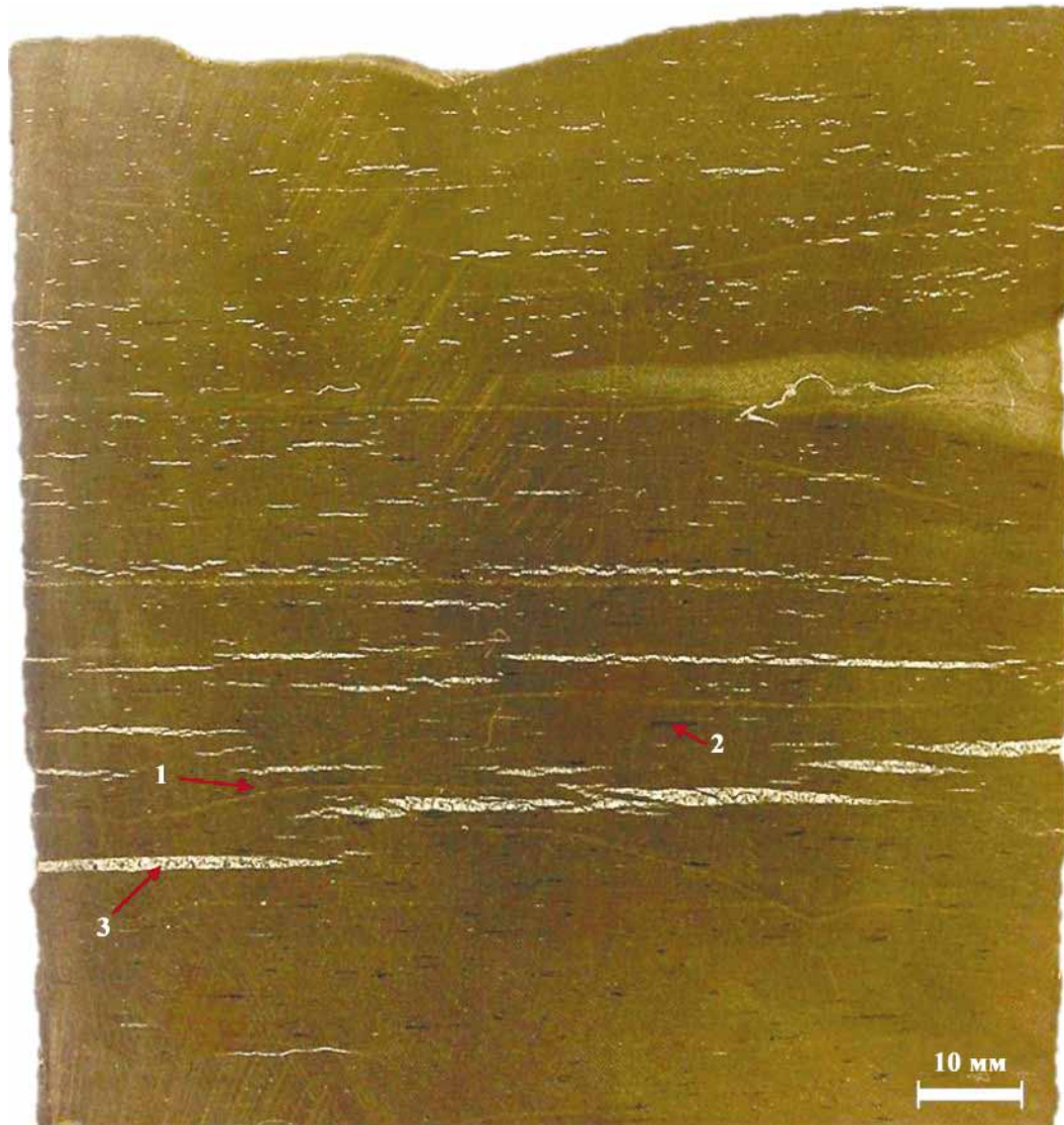
Рис. 7. Образец керна с тремя типами трещин.
