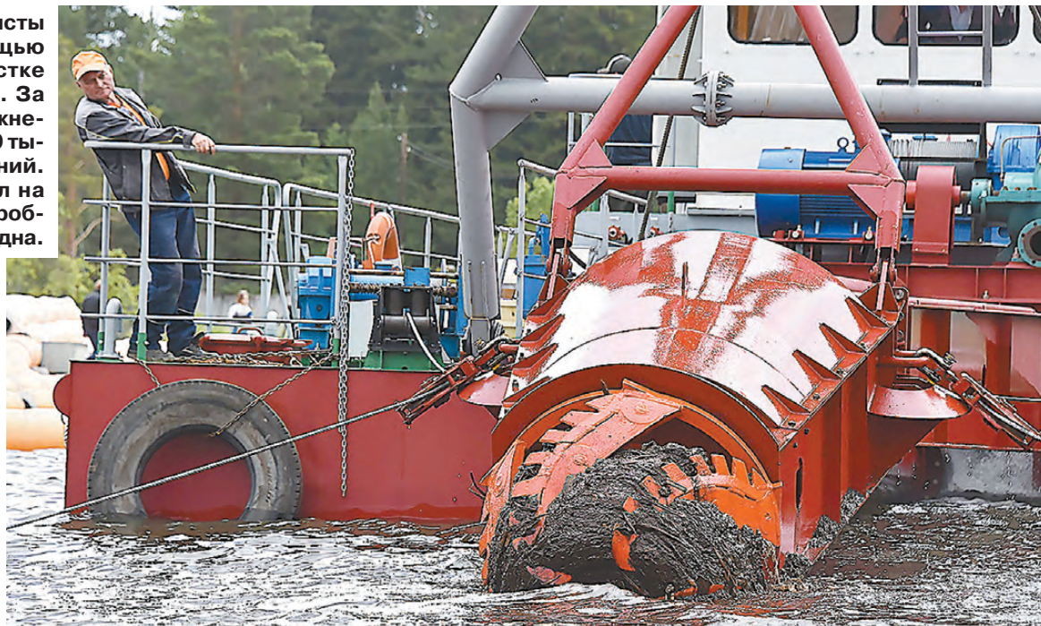
Головка-фреза разрыхляет донные отложения.
