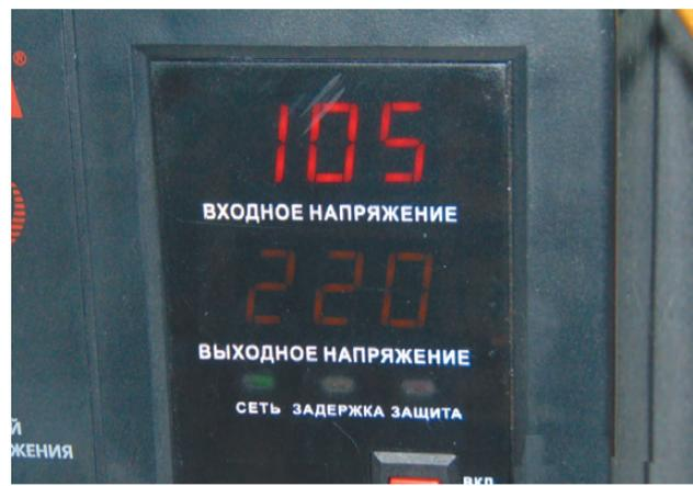
*Показания стабилизатора за 13 июня этого года. При входном напряжении 83 Вт стабилизатор автоматически отключается. Такое, по словам В. Спицына, происходит достаточно часто.*
