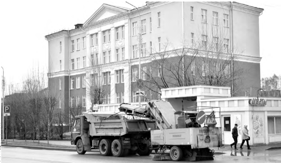
Машина «Бродвей» в действии: грязь и отсев с дороги перемещаются в кузов грузовика
