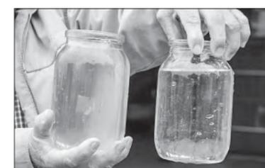
Так выглядит вода до и после очистки в цехе химводоподготовки
