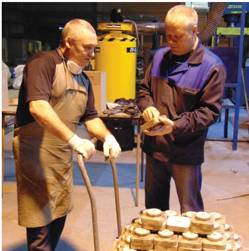
Стаканы-дозаторы для систем разлива стали CNC цех делает для челябинских, тюменских металлургов, для «Магнитки».
