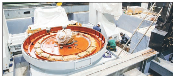
▲ Диаметр рабочего стола нового станка – четыре метра
