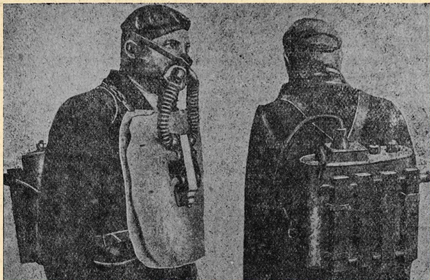
Фиг. 5. Кислородный прибор с жидким воздухом горного инж. Левицкого „Макеевка“.
