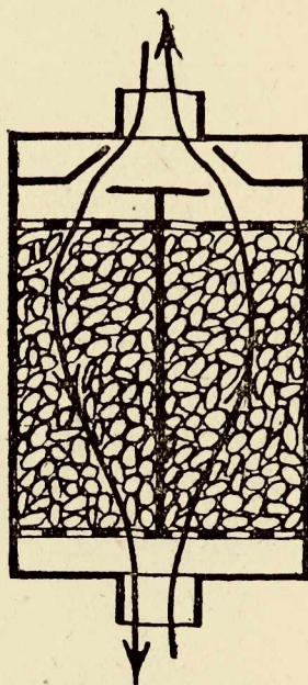
Фиг. 42. Схема коробки Авалова 1 образца.
