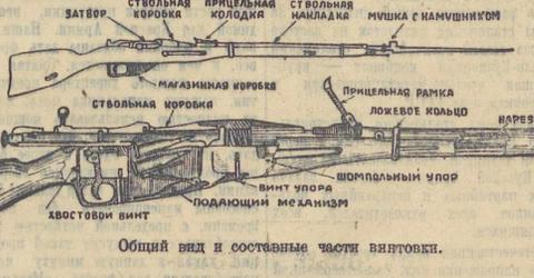
Общий вид и составные части винтовки.
