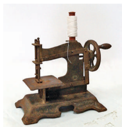
Детская швейная машинка цепного стежка с литым художественным корпусом, производство – Западная Европа, 1910-1930 год выпуска.
