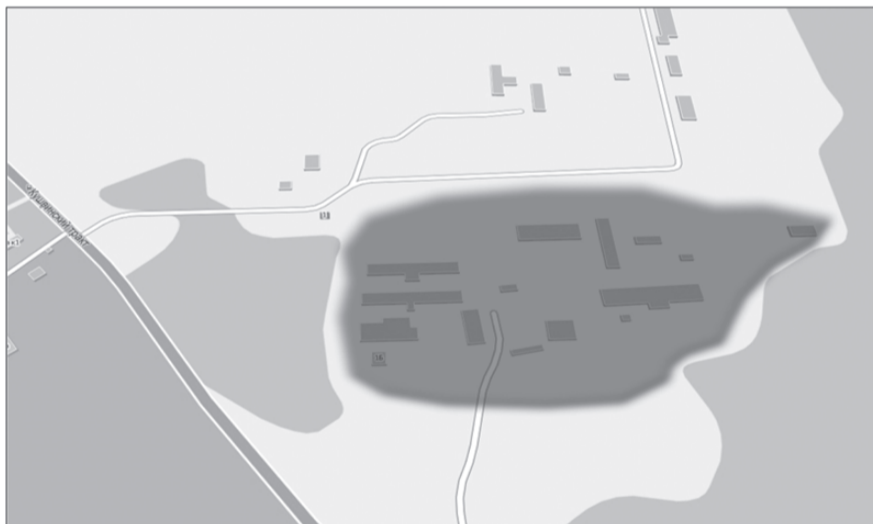
Рисунок 2.1.1.34. Существующая зона действия котельной «Зеленстрой»
