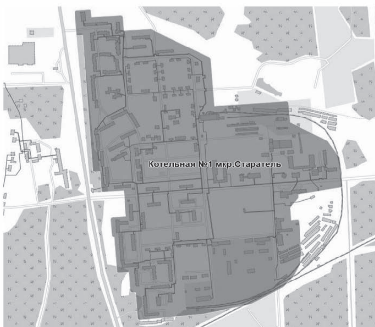
Рисунок 2.1.1.47. Перспективная зона действия котельной № 1 п. Старатель
