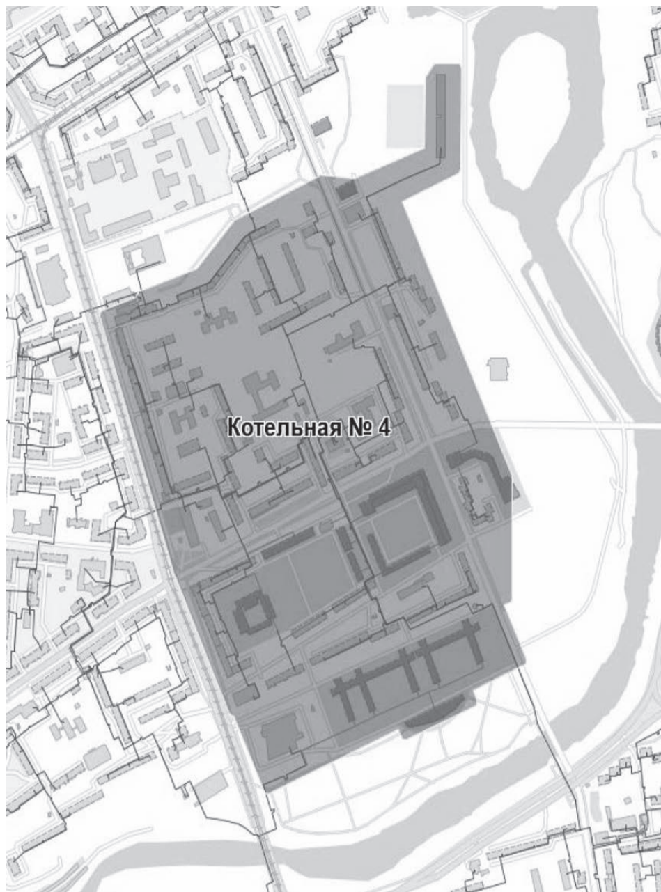
Рисунок 2.1.1.20. Перспективная зона действия котельной № 4
