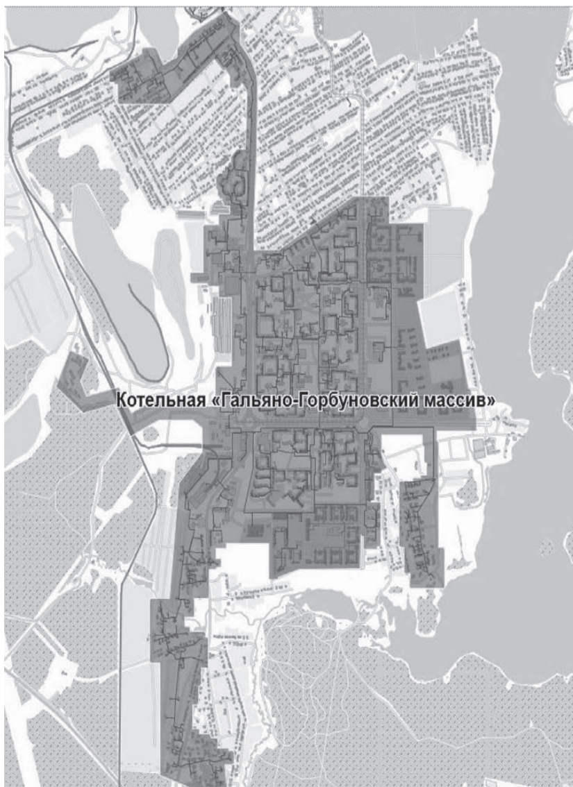
Рисунок 2.1.1.2. Перспективная зона действия котельной «Гальяно-Горбуновский массив»
