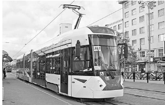
Для новой модели трамвая не требуется реконструкция рельсов и контактной сети, остановочных комплексов или депо — он может эксплуатироваться на действующей инфраструктуре.
