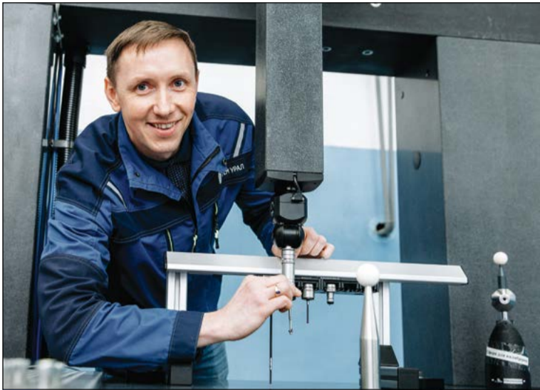
Евгений Смирнягин демонстрирует магазин инструмента и операцию его замены
