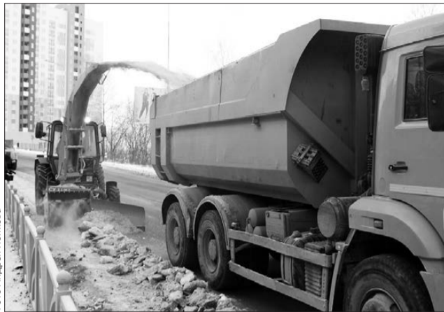
Шнекоротор способен убрать 500 тонн за час
