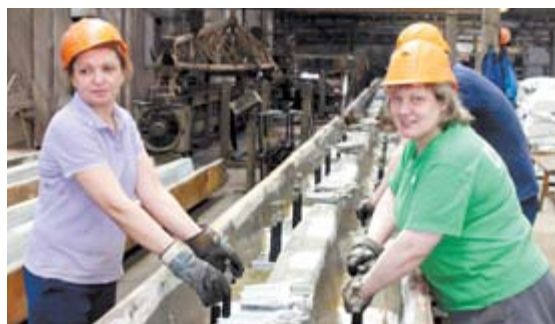
С. Куренная (слева) и А. Шибегутдинова в процессе подготовки форм, установки закладных деталей
