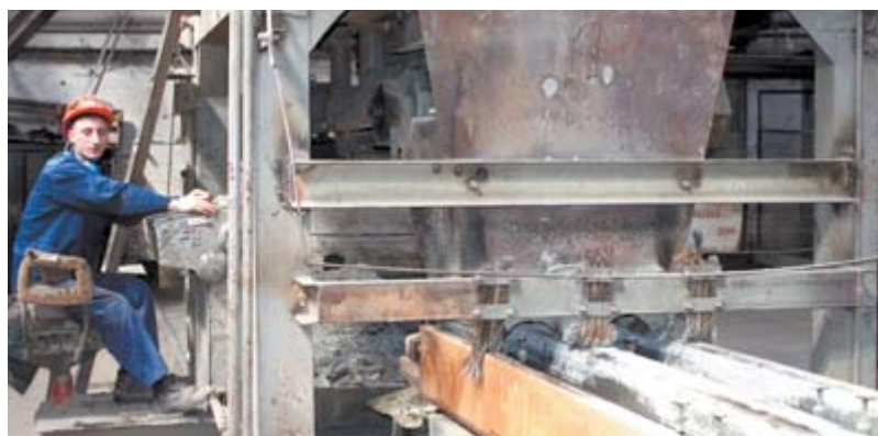
Формовщик А. Никонов укладывает готовую бетонную смесь в формы
