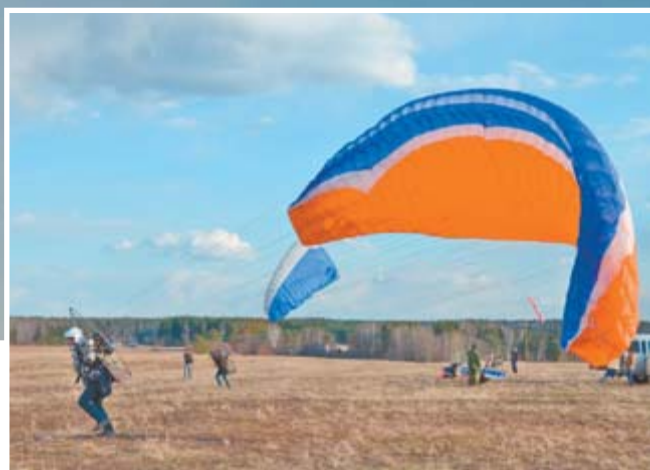
■ Ранцевый мотопараплан весит около 15 кг.
