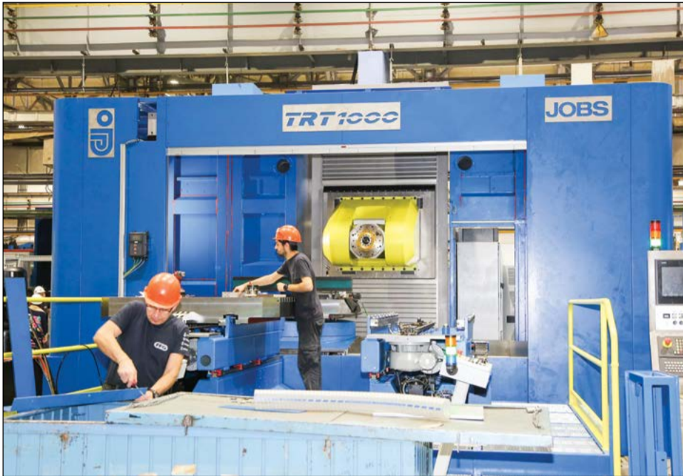
На втором станке идёт проверка на геометрическую точность
