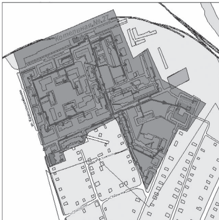
Рисунок 2.1.1.30. Существующая зона действия котельной № 27
