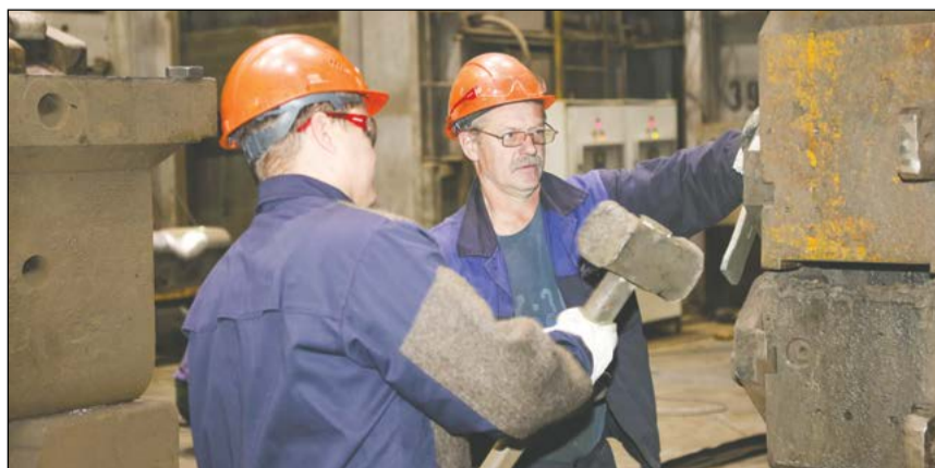
Кузнец Ярослав Полукаров и слесарь-инструментальщик Андрей Кулигин затягивают гайки верхнего бойка
