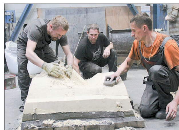
Один из этапов изготовления литейной формы. Золотистый песок – это холодно-твердеющая смесь. Застывая, она способна удерживать раскалённый металл
