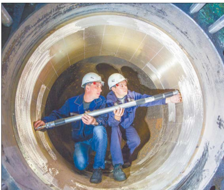
Рузаль Димухаметов и Николай Казанцев из цеха № 50 замеряют внутренний диаметр рабочего цилиндра
