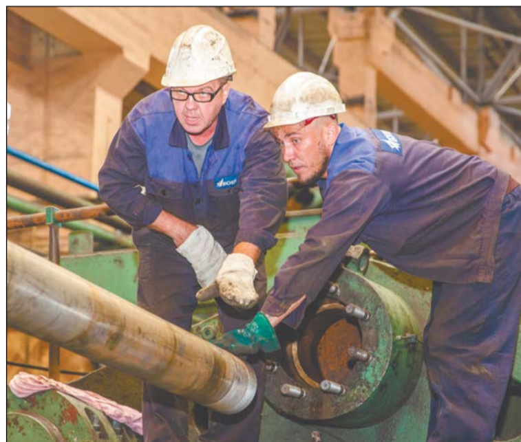
Слесари цеха № 50 Сергей Верзаков и Иван Решетов устанавливают плунжер возвратного цилиндра
