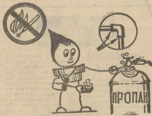
Мыльной эмульсией легко найти место выхода газа из газопровода или прибора. Трест Первоуральскемрайгаз.
