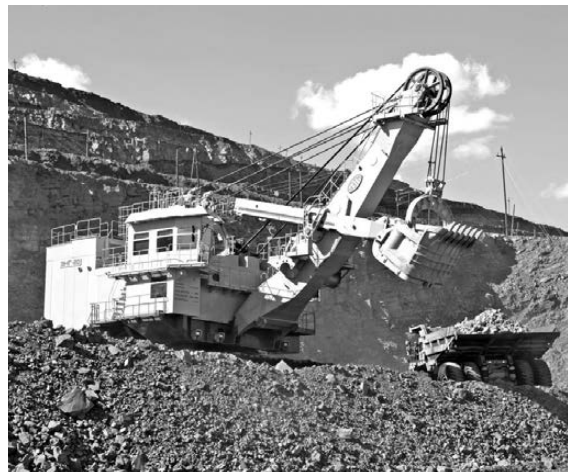
Особая конструкция 20-кубового ковша обеспечивает максимальный коэффициент его заполняемости, что существенно влияет на объем экскавации.
