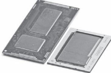
Оба процессора производятся по 14-нанометровой технологии и содержат два вычислительных ядра с возможностью обработки до четырех потоков инструкций. Поддерживается оперативная память LPDDR3-1866 и DDR3L-1600. За обработку графики отвечает встроенный контроллер Intel HD Graphics 615 с частотой до 900 МГц.
