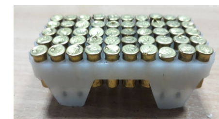
Общий вид гильзы от спортивно-охотничьих патронов кольцевого воспламенения калибра 5,6 мм в количестве 50 штук в пластиковом футляре белого цвета
