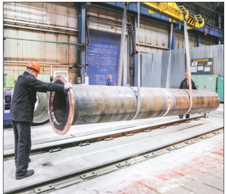
Медный кристаллизатор привезли на рентген-контроль
