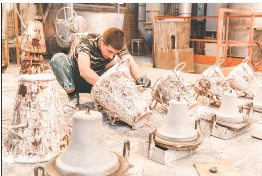
Низ и верх соединят, а в полость между ними зальют бронзу
