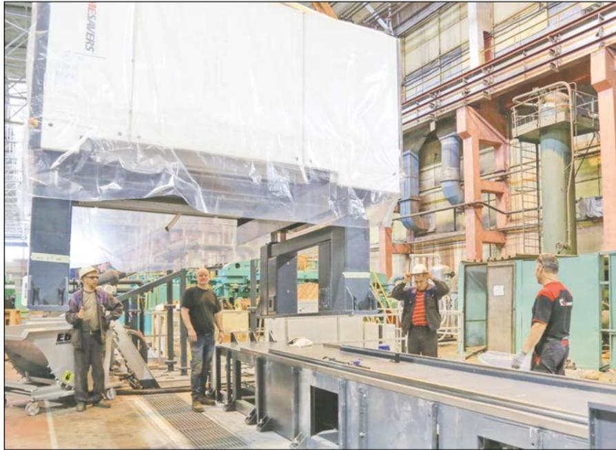
Установка самого габаритного узла станка
