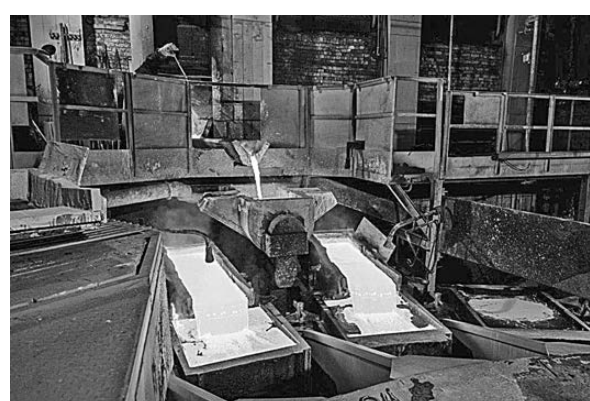
В рамках программы техперевооружения медеплавильного цеха ранее были модернизированы разливочные комплексы двух печей и один построен заново.
