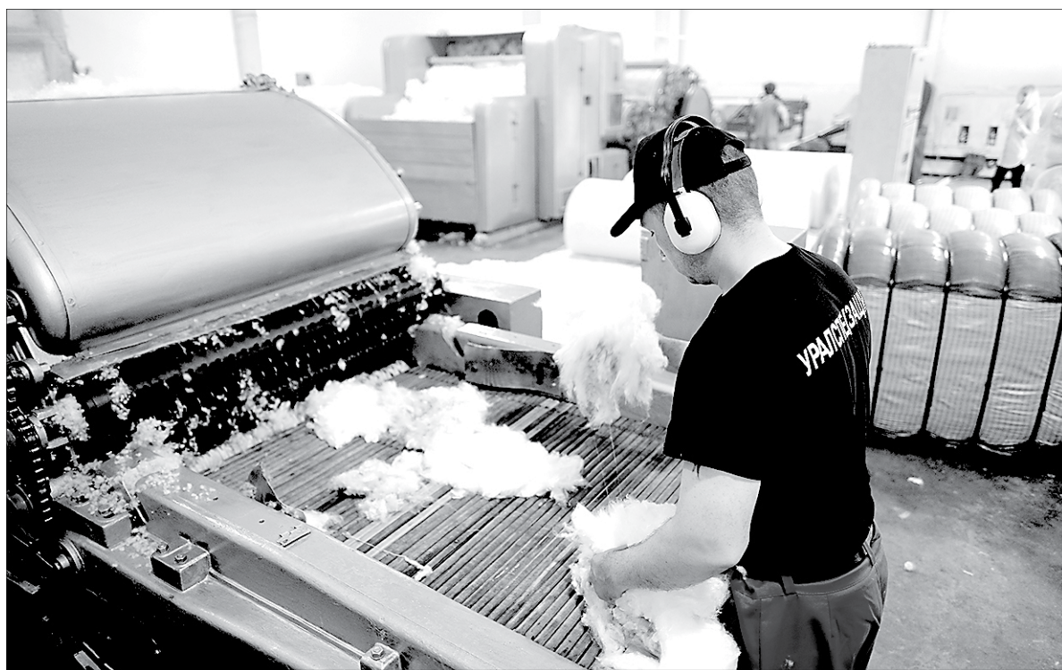
Линия по производству синтепона на предприятии «Уралспецзащита»
