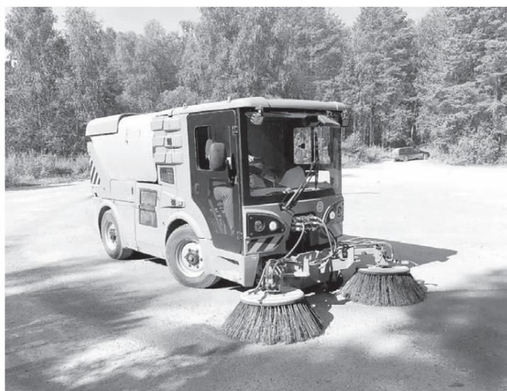
Напомним, эта шустрая малышка может очищать любую поверхность с твердым покрытием, производя подметание, пневматическое транспортирование (всасывание) смета в бункер - мусоросборник и его разгрузку самосвальным способом. Уличный пылесос может стать хорошим подспорьем дворникам, ведь техника может убирать грязь в считанные минуты, очищать даже самые труднодоступные места, трудиться при отрицательных температурах (до -25°C).
