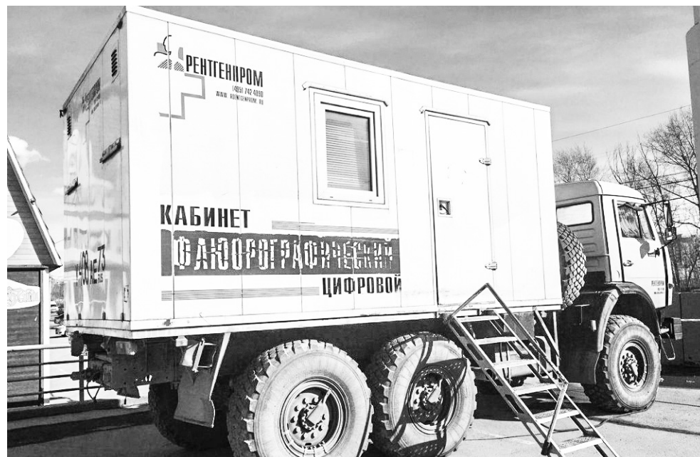
в села приезжают передвижные установки на базе автомобиля КамАЗ, оснащённые современными цифровыми мало дозовыми рентгеновскими аппаратами
