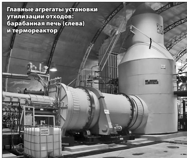
Главные агрегаты установки утилизации отходов: барабанная печь (слева) и термореактор
