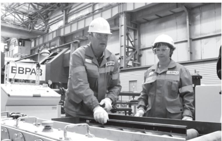
На завершающем этапе производства рельсовой накладки
