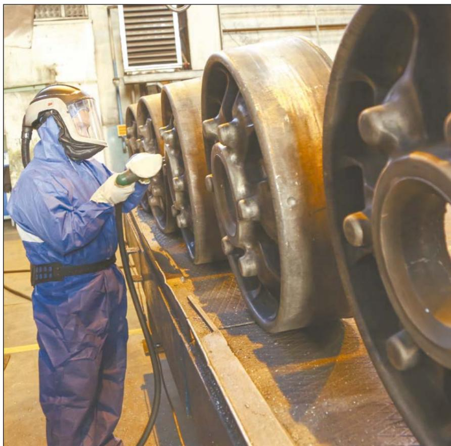
За смену обработчик зачищает до 120 штамповок под надёжной защитой спецкостюма
