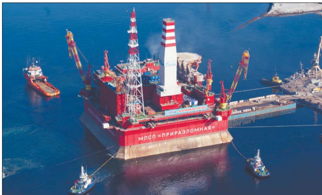
«Приразломная» – морская ледостойкая стационарная платформа
