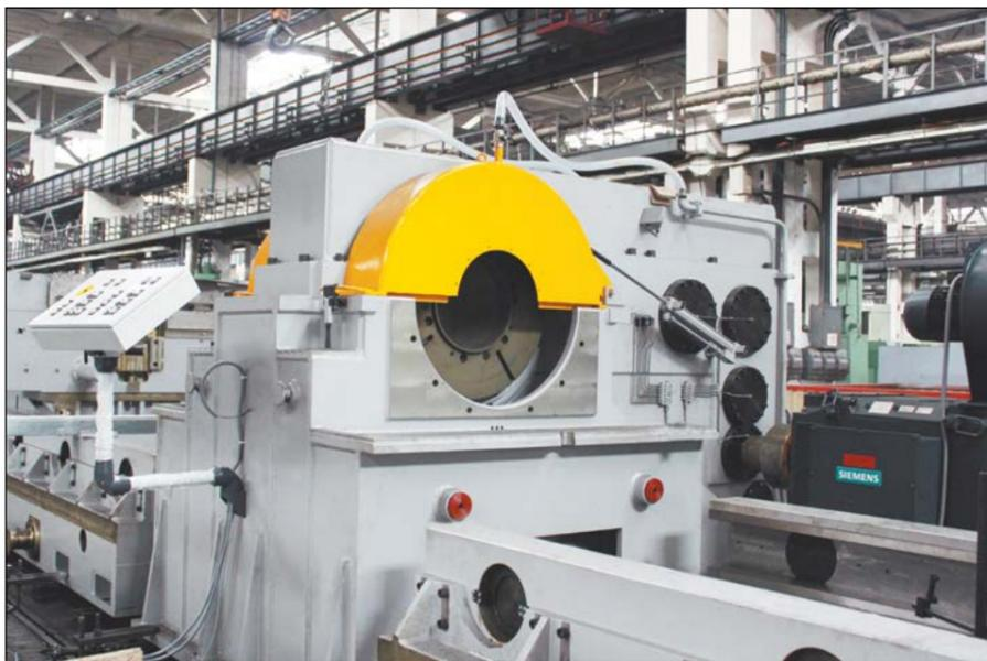
Шпиндельный узел предназначен для осуществления главного движения резания – вращения резцовых головок
