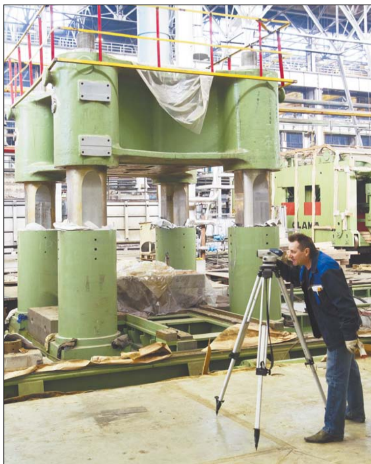
Общий вид пресса-4 000. Мастер цеха № 50 Алексей Поляков выводит в горизонт «магазин» смены инструмента
