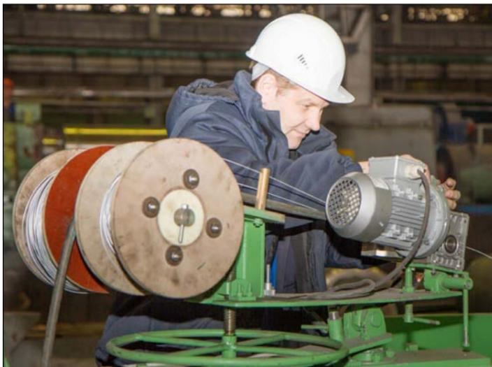
От настройки нового металлатора зависит скорость напыления защитного слоя
