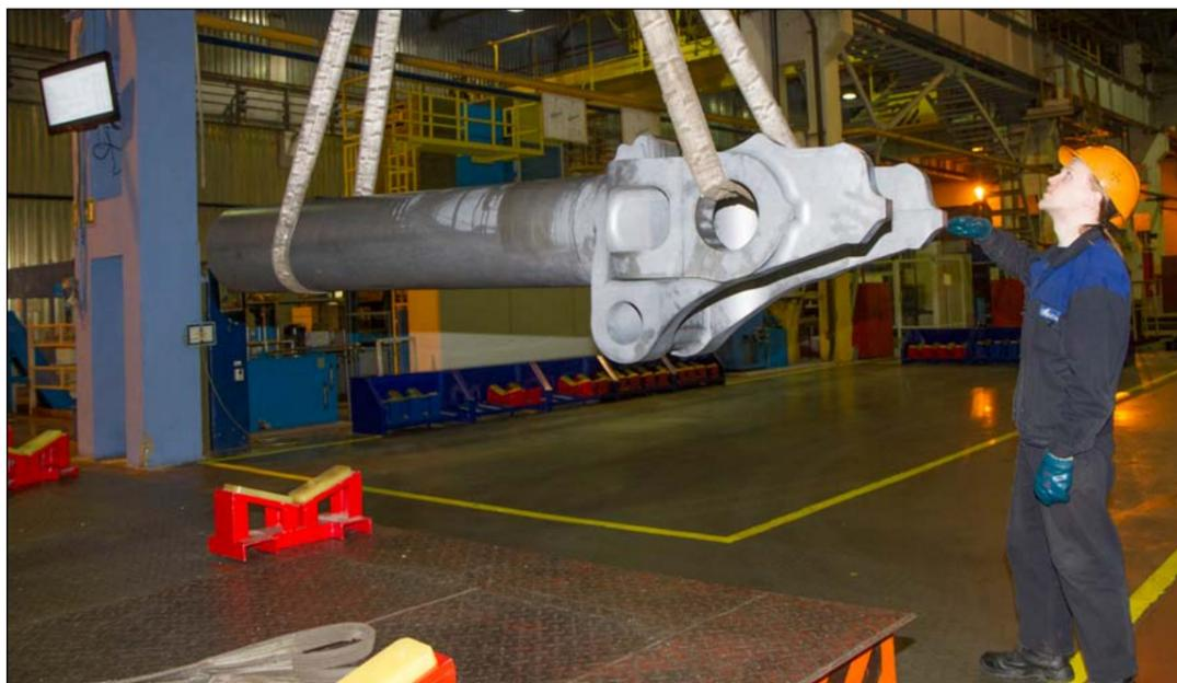
Станочник Иван Попов транспортирует на участок сдачи обработанную штамповку внутреннего цилиндра шасси самолёта Boeing 787
