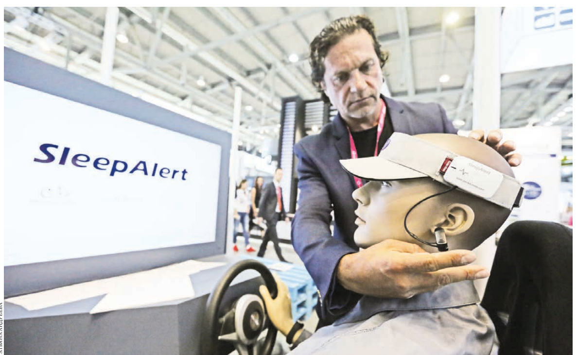
Sleep Alert определяет состояние человека, которое может спровоцировать ДТП, и предотвращает его подачей вибрации на браслет.
