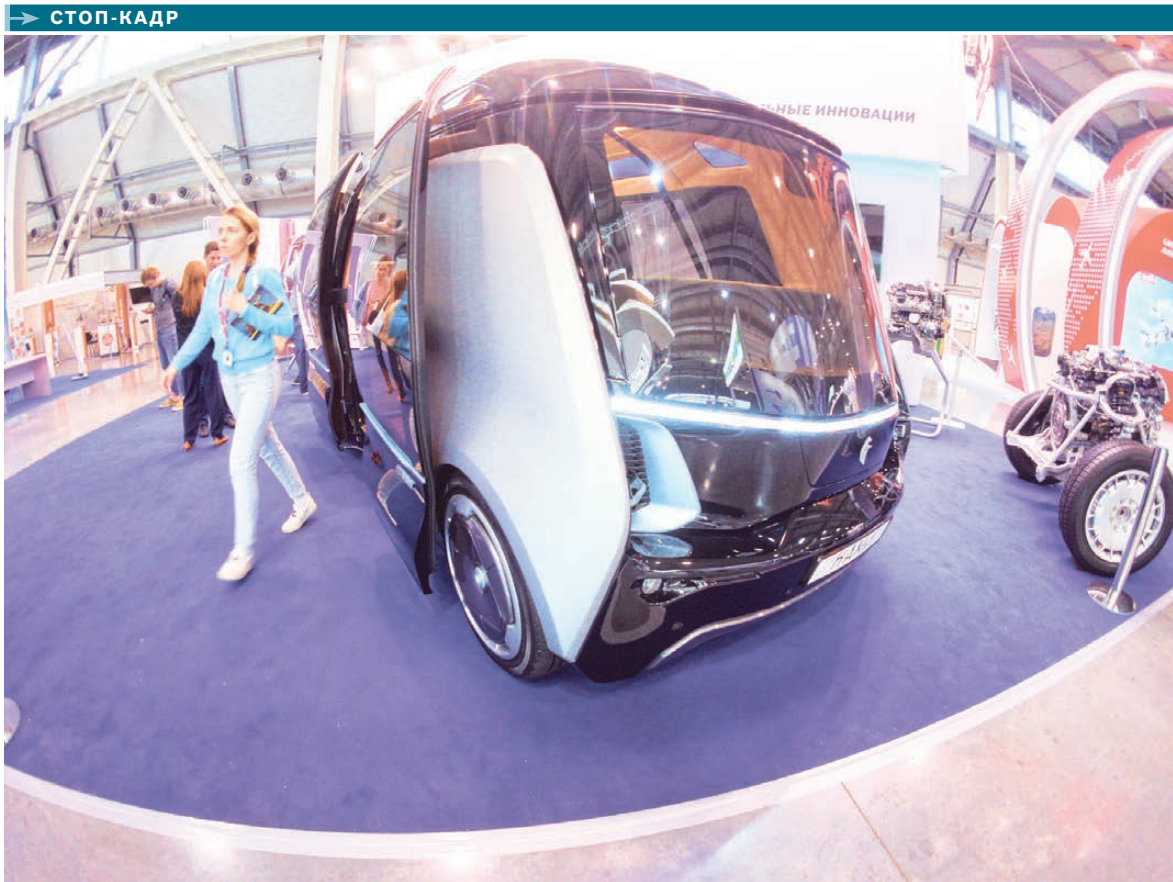
Одним из наиболее популярных экспонатов проходящей в Екатеринбурге выставки «Иннопром» стал прототип беспилотного электрического микроавтобуса. Разработка КамАЗа, Яндекса и Центрального научно-исследовательского автомобильного и автомоторного института не имеет руля. Все, что необходимо аппарату для перевозки пассажиров, — компьютерная программа и дорожная разметка. Производители рассчитывают опробовать автобус буквально через год: на чемпионате мира по футболу в России.
