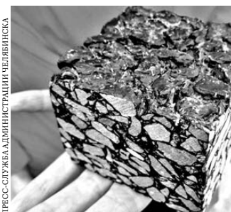
Так выглядит щебеночно-мастичный асфальтобетон.
