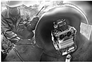
Робот-дефектоскоп обследует теплосети, двигаясь внутри трубы.
