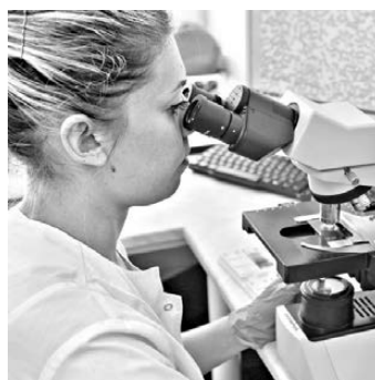
В клинической лаборатории ОКБ № 3 используют «умные микроскопы», которые сами подсчитывают число кровяных телец.
