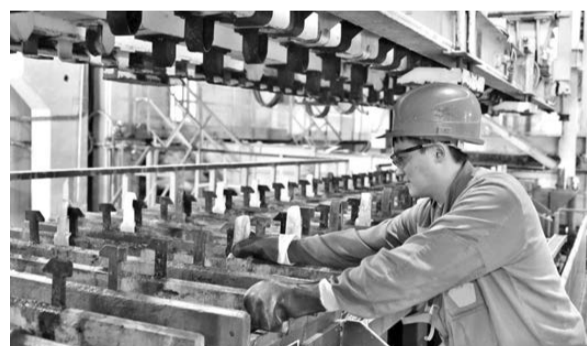
Вес одного свинцово-серебряного анода — 275 килограммов, площадь — 3,9 квадратного метра. Всего в ванне находится 81 анод, которые кран переносит в машину за четыре подъема.
