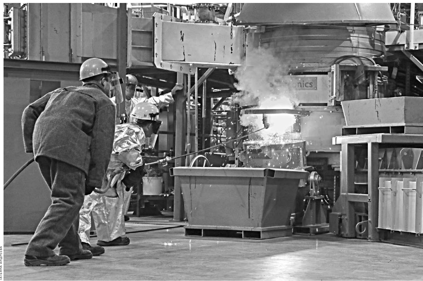
В Верхней Пышме открыли комплекс плазменной плавки, где из минерального и вторичного техногенного сырья извлекаются благородные металлы. Новая линия сможет перерабатывать до 1000 тонн сырья в год: катализаторы нефтехимии, автокатализаторы, отвалы и хвосты горнодобывающих предприятий, электронного лома и т.п. Планируемые объемы извлечения драгметаллов — до 600 килограммов в год. Это финальный этап крупного инвестиционного проекта (стоимостью порядка миллиарда рублей), который реализуется с 2013 года. Сначала открыли лабораторию пробирной плавки, в 2014-м — автоматизированную линию пробоотбора и пробоподготовки.
