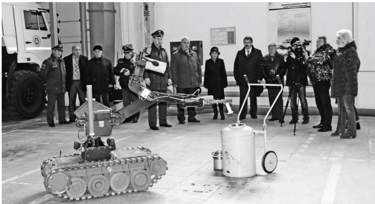
Демонстрация ликвидации самодельного взрывного устройства при помощи роботизированного комплекса MF-4.
