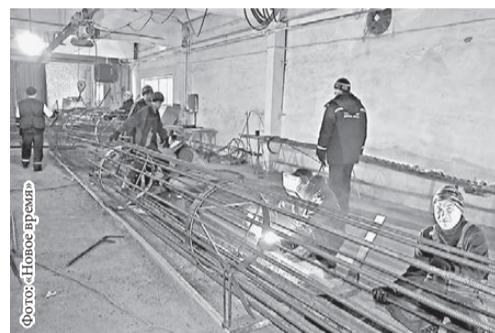
На заводе «Жасмин» запущено новое бетонное производство. Здесь есть станки контактно-стыковой сварки, привально-обрезной станок. Они позволяют выпускать продукцию для гражданского и мостового строительства. Технолог Ирина Войтова отмечает, что, если в старом бетонном узле на производство одного «куба» бетона уходит до шести минут, то на новом – 36 секунд! Узел укомплектован датчиками влажности и температуры. Все работы контролируются автоматически.
