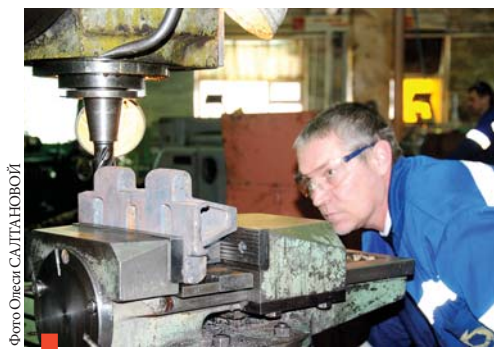
Фрезеровщик Денис Чупин за обработкой трака
