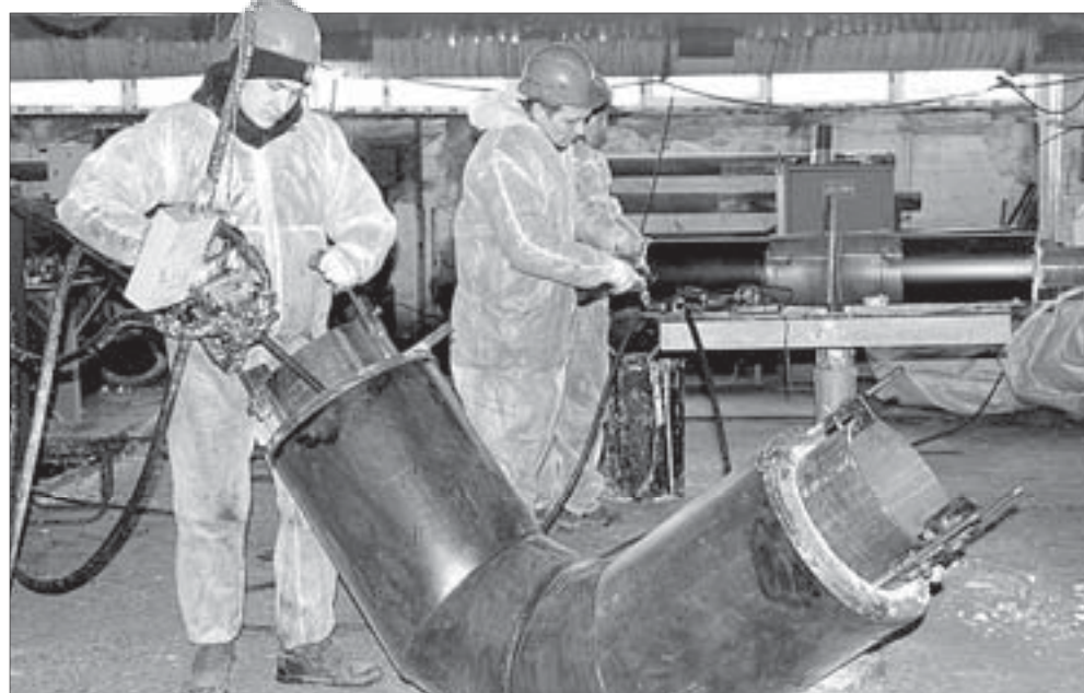
Трубы в ППУ-изоляции могут эксплуатироваться при температуре окружающей среды от -80°C до +130°C
