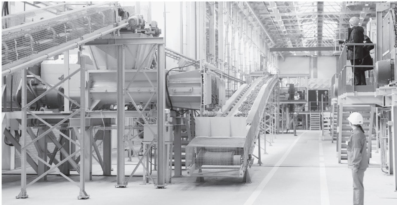
Новый цех «Ревдинского кирпичного завода» (УГМК) с апреля 2016 г. начал выпускать крупные керамические блоки, которые позволят быстрее и экономичнее строить.
